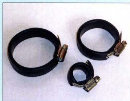
Bild 7: Einige der vorbereiteten Mastschellen von Spiderbeam Fotos: DJOIP (1), FA (3)
