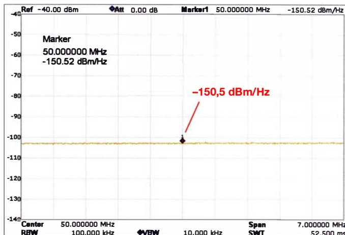
Bild 6: Die Messung des Rauschens über die Noise-Marker-Funktion, mit Verstärker, liefert hier den Wert P_{NA} = -150,5 dBm/Hz. Screenshots: DC4KU
