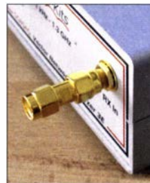
Bild 6: Qualitäts-SMA-Adapter zum Direktanschluss des VNWA3 an die zu messende Sendeeinheit
