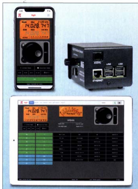
Bild 4: Zur Fernsteuerung mittels RigPi Station Server MFJ-1234 (oben rechts) lassen sich auch Smartphone oder Tablet-PC nutzen.
