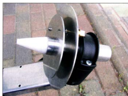
Bild 2: Duoband-Feed im LNB-Halter eines Offsetspiegels Fuba DAA 110
