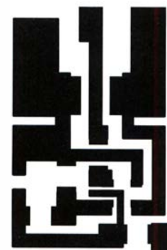
Bild 5: Layout der Bestückungsseite der einseitig kaschierierten Platine; Originalabmessungen 15,24 mm x 22,86 mm, hier M 2:1
