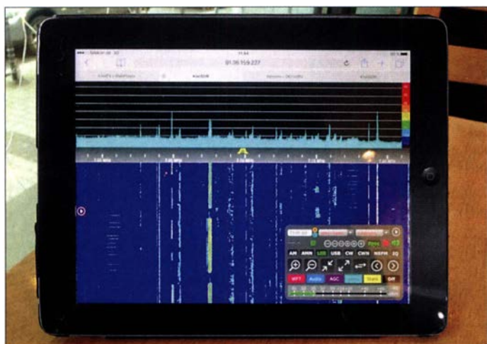
Bild 7: Bedien- und Anzeigeoberfläche des KiWi-SDR, hier auf einem Tablet-PC
