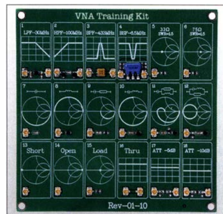
Das VNA-Übungs-Kit enthält auf der Vorderseite insgesamt 18 Messobjekte der HF-Technik, einschließlich der dazugehörigen Miniatur-Koaxialbuchsen. Foto: FA
