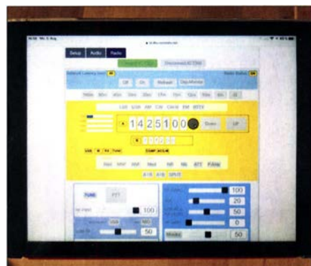
Bild 6: Bedienoberfläche der Software RemoteTx auf einem Tablet-PC, hier bei der Fernsteuerung eines IC-7300
