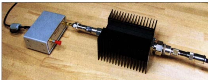
Bild 1: Laboraufbau für eine 2,4-GHz-Leistungsmessung mit dem VNWA 3, hier mit vorgeschaltetem Hochlastwiderstand mit 40-dB-Messausgang sowie einem weiteren 30-dB-Dämpfungsglied
