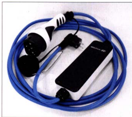
Bild 1: Typisches Ladekabel mit integrierter Kontrollbox und Schutzkontaktstecker an einen sowie Typ-2-Stecker am anderen Ende Fotos: DJ4WD
