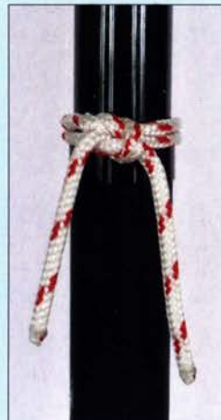
Bild 4: Möglichst flexibles, dickes Seil als Alternative für einen Gurt; der Achterknoten liegt auf dem um den Mast gelegten Seilstück auf. An den beiden Enden lassen sich mit je einem Schotstek die dünneren Abspannseile befestigen.
