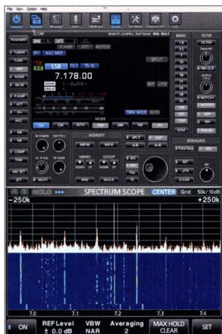
Bild 1: Bedienoberfläche von RS-BA1 mit zusätzlichem Spektrogramm bei der Fernsteuerung des IC-7300
